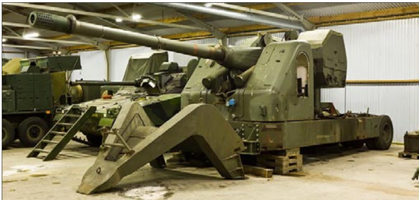
Kronan bland de automatiska pjäserna är dock vår 12 cm Ivakan försöksmodell 1. Denna pjäs som är världens största mobila lvpjäs togs fram av Bofors efter VK II som ett alternativ till att utveckla robotsystem.
