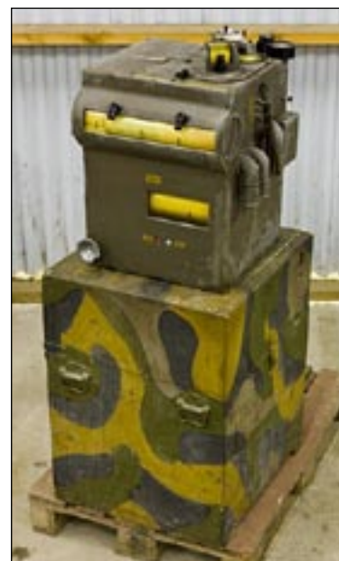
Centralinstrument m/ä. Konstruktör kapten Halvar Gustavsson. Ingångsvärden: avstånd, fart och kursvinkel. Fartregister: 0-80 m/s. Antal: 22. Användes 1922-1937.
