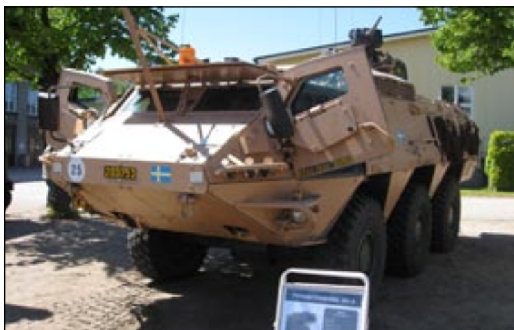
Pansarterrängbil 203 A, utrustad bl a med 20 mm akan och rökkastare.
